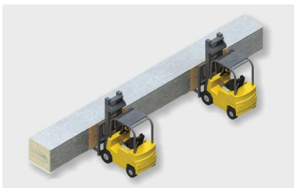
(ukázka vykládání panelů se dvěma vysokozdvížnými vozíky)
